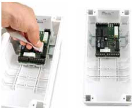
2. Отсоедините плоский шлейф от разъема, чтобы снять переднюю часть контроллера.
